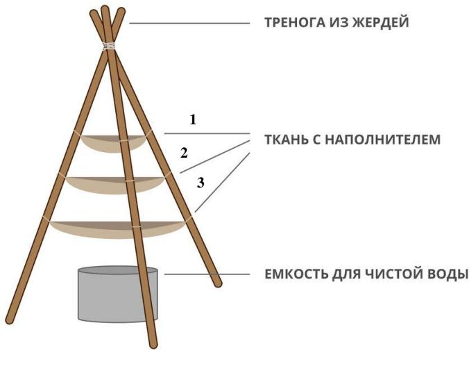
1. Устанавливаем жерди в виде треноги, прикрепляем куски ткани на одинаковом расстоянии друг под другом.
